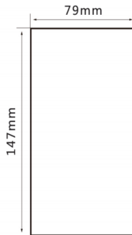
Рис. 2.6- Размеры под монтажное отверстие для панели управления ( \geq 30 кВт)
