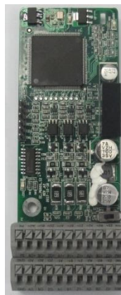
Многофункциональная инкрементная PG-плата EC-PG505-12
