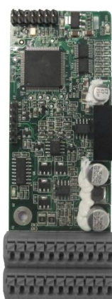
Резольвер PG-плата EC-PG504-00
