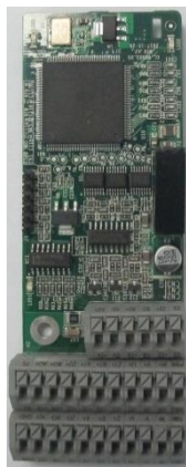
UVW инкрементная PG-плата EC-PG503-05
